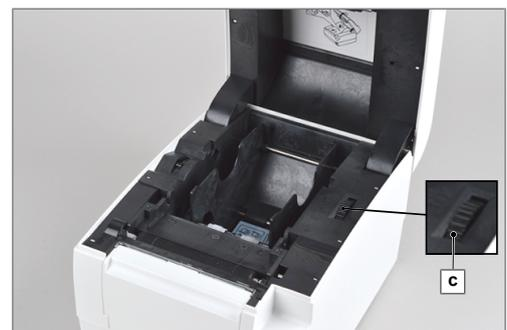
3. Nehmen Sie die Etikettenrolle mit den schmaleren Etiketten (5 cm breit) und setzen Sie sie mittig in den Rollenhalter.
