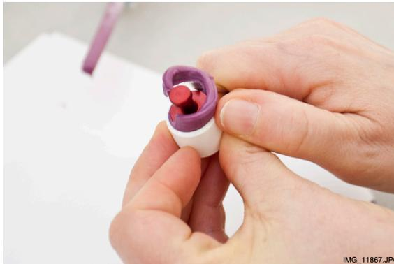
5. Ziehen Sie den Kalibrierstift vorsichtig heraus, und vergewissern Sie sich, dass die Oberflächen der mit dem Kalibrierstift geformten Vertiefung glatt sind (keine Luftblasen in den Innenwänden).
