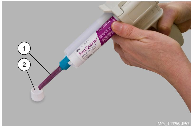
2. Drücken Sie den mitgelieferten Kalibrierstift (Artikelnummer 10031265) mit dem dickeren Ende nach unten in das Material, bis der Mittelring mit der Oberkante der Kalibrierhülse abschließt.
