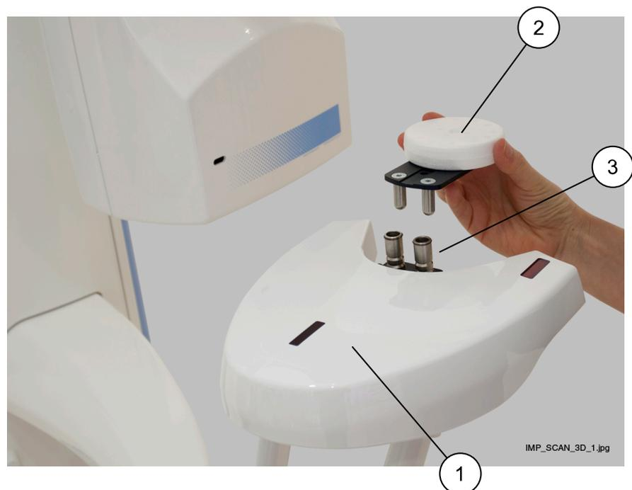
2. Positionieren Sie den verstellbaren Adapter:
