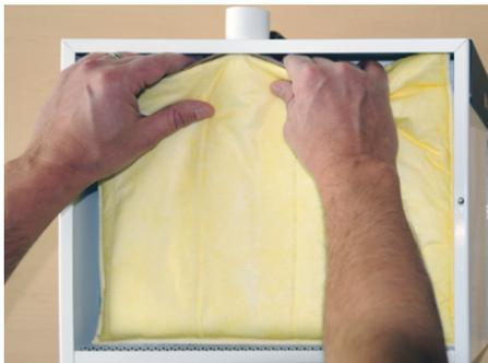
3. Ziehen Sie den Filterbeutel vom Stutzen ab und stecken einen neuen Filterbeutel auf.
