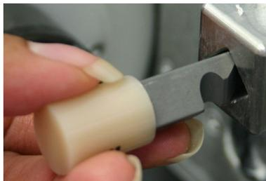
Wenn der Block nicht vollständig eingesetzt werden kann, lösen Sie den Exzenter, indem Sie ihn mit dem T-Griff der Spindel um 180 Grad gegen den Uhrzeigersinn drehen.
