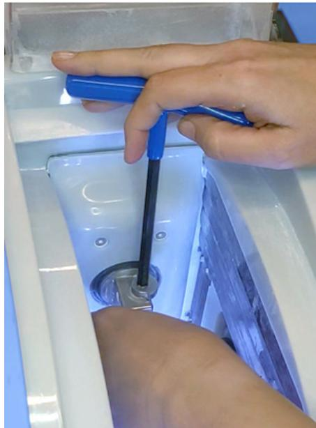
2. Bringen Sie den Block in die korrekte Position, und verriegeln Sie ihn durch Festziehen des Exzenters.
