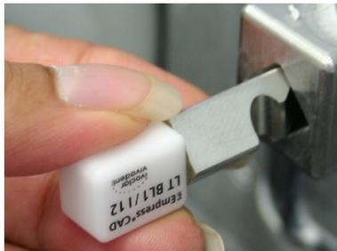
Runde Blöcke werden mit vertikaler Orientierung eingesetzt.
