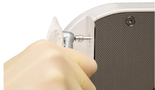
5. Drücken Sie das Instrument so oft kurz auf die Düse, bis Öl am Instrumentenkopf austritt.
