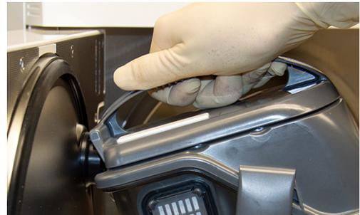
3. Führen Sie die Carebox langsam an die untere Halterung bis die Magnetverbindung greift.
