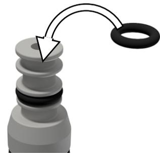
3. Kontrollieren Sie die Adapterdichtung auf korrekten Sitz.
