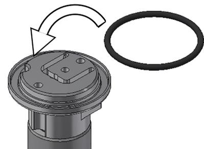
6. Setzen Sie den neuen Adapter ein, indem Sie ihn nach der Auskerbung ausrichten.
