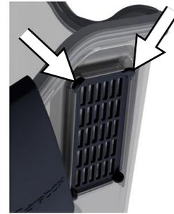
3. Entfernen Sie den alten Carebox Filter mit Hilfe einer der Kunststoffnasen der Abdeckung.
