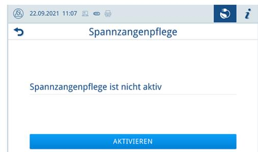
4. Drücken Sie das Instrument mit entriegelter Spannzange kurz auf die Düse, um eine Spannzangenpflege durchzuführen.
