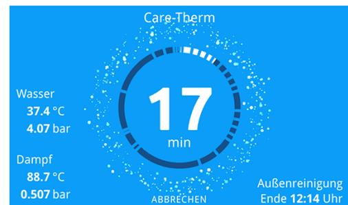
→ Während des Programmlaufs werden auf dem Display die aktuelle Programmdauer, die aktuellen Parameter und das voraussichtliche Programmende angezeigt.
