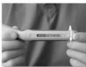
Pour remplacer la pile, saisir fermement la pièce à main dans sa partie angulée avec une main, et commencer à tourner dans le sens inverse des aiguilles d'une montre le bouton qui se trouve à l'autre extrémité avec votre autre main.
