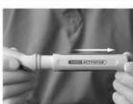
tourner la vis pour désengager progressivement la protection de la pile et la retirer de la pièce à main. La remplacer par une pile neuve de haute qualité au Lithium.
