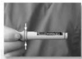
Om het compartiment te sluiten schuift u de huls over de nieuwe batterij en positioneer het EndoActivator logo als hierboven afgebeeld. Breng de oriëntatiemerken in één lijn in de groeven en draai de schroefdop in de richting van de klok totdat hij vast zit.
