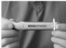
Pak om het batterijcompartiment van het hoekstuk te nemen het gebogen deel van het hoekstuk met een hand stevig vast en begin met de andere hand tegen de klok in te draaien aan de niet verwijderbare schroefdop.
